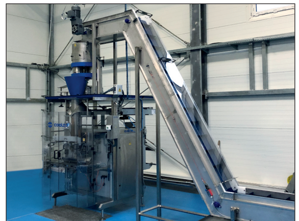
Individuelt designet WESSAMAT-transportørteknologi med automatisk påfyldnings- og pakkeenhed til isterninger og knust is.
