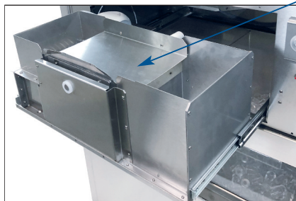
Den udtrækbare glideanordning gør rengøring af crusher-moduliet nemt.
