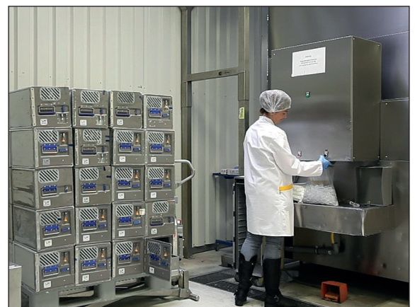
Isproduktion med halvautomatisk fyldning af hule isterninger til flyselskabers catering.
