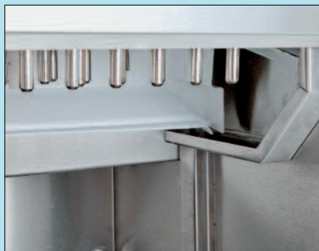
Absenkbare Wanne und U-förmige Ablaufrinne zur kontrollierten Restwasserentleerung
