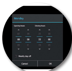
Med "ØKO-funktionen" kan du styre dit strømforbrug effektivt. Du kan indstille køleren til automatisk at hæve temperaturen i lukketiden og kun opretholde en lav temperatur i køleren, når det er påkrævet, i åbningstiden. Med denne funktion opnås en markant daglig strøm-besparelse. Det betyder at den højere indkøbspris for møblet, sammenholdt med almindelige barkølere, kan tjene sig hjem flere gange i møblets levetid.
