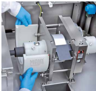
Ausbau der Wasserwanne zum Reinigen
