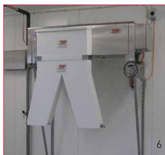
RVH auf Wandkonsole mit Hosenschacht
